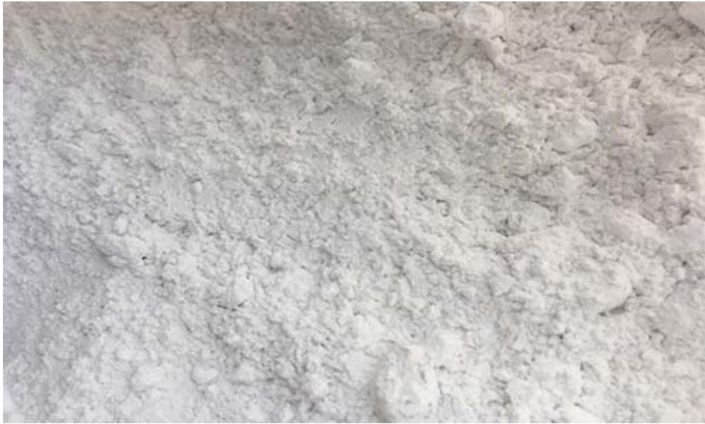
是由有机高分子材料研制成的，易溶于水，兑水后，直接涂刷于模板后形成一层很滑的隔离膜，该膜能完全阻止混凝土与模板的直接接触并且有助于在浇注混凝土时，混凝土与模板接触处的气泡能迅速溢出，使梁柱不会出现气孔，美观。使用之后不影响混凝土的强度，对钢筋无腐蚀作用。, 无害，绿色产品。传统的机油，称油性脱模剂，其粘性及稠度高，气泡不容易溢出造成拆模后表面出现气孔，并且严重影响后续表面抹灰砂浆与混凝土基层的粘结力，影响工程质量。使用水性脱模剂应注意的几点事项：1、使用前应将模板清理干净，去掉水泥残留物、油污染。
